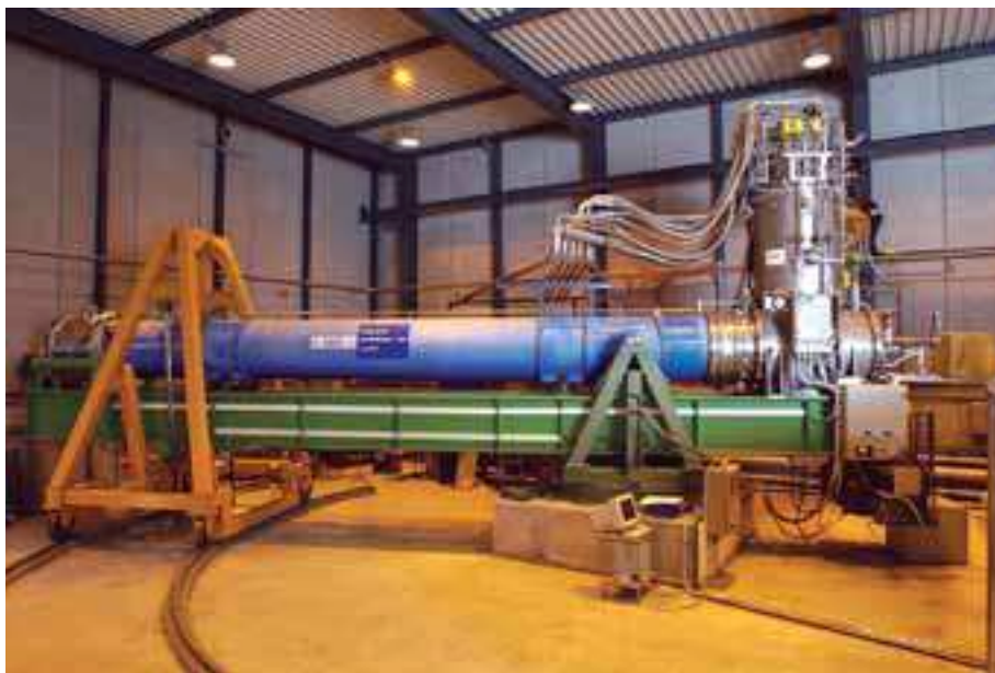
CERN-ov teleskop za Sunčeve aksione sastoji se od 10 metarskog LHC test magnet nominalne jakosti 9 Tesla, montiranog na pokretnu platformu koja omogućuje praćenje Sunca oko tri sata dnevno.
