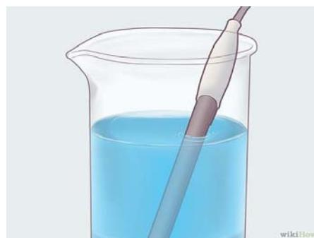
3. Prije uranjanja u uzorak eletrodu trebamo oprati i posušiti.
