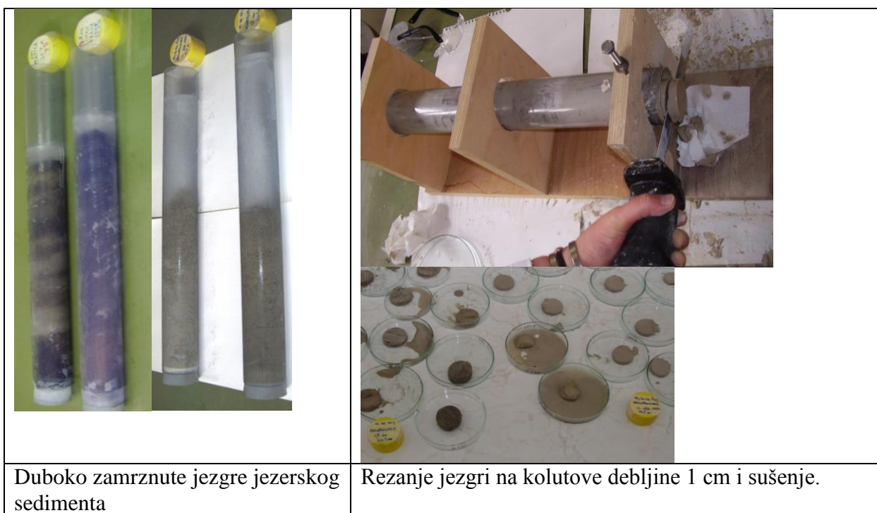
Priprema grafita za ^{14}\text{C} -AMS analizu i određivanje \delta^{13}\text{C}
