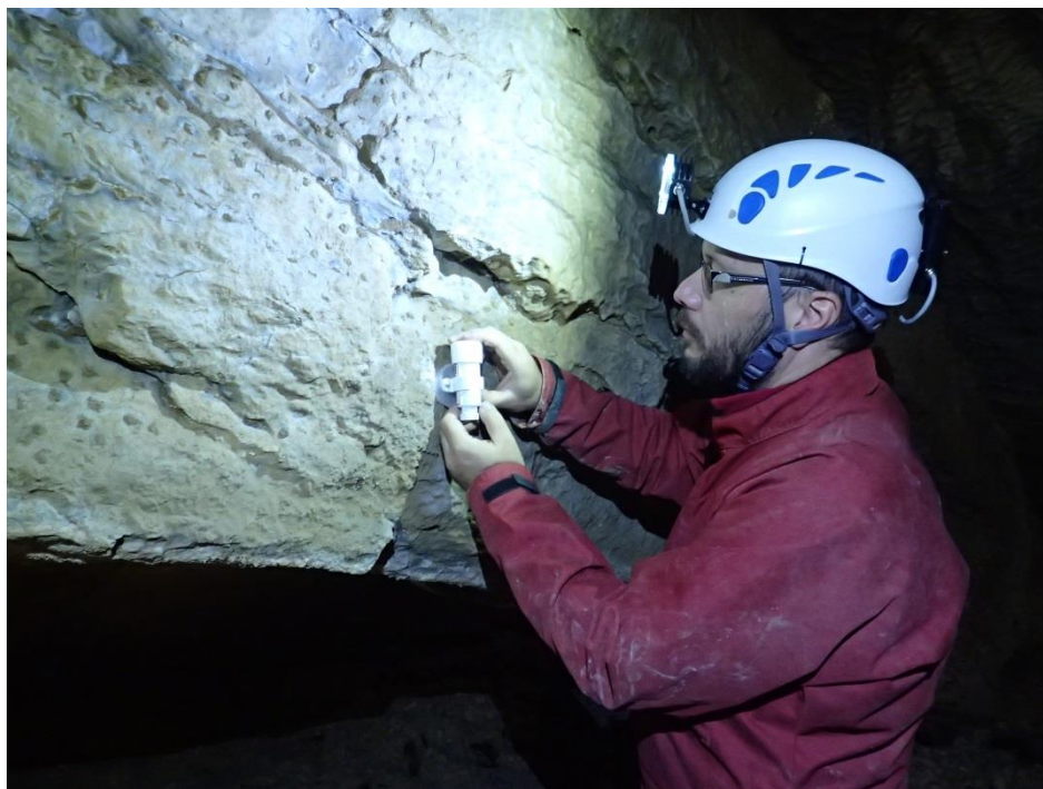
Postavljanje TH loggera u Lokvarci (bilježi temperaturu i relativnu vlažnost zraka)
